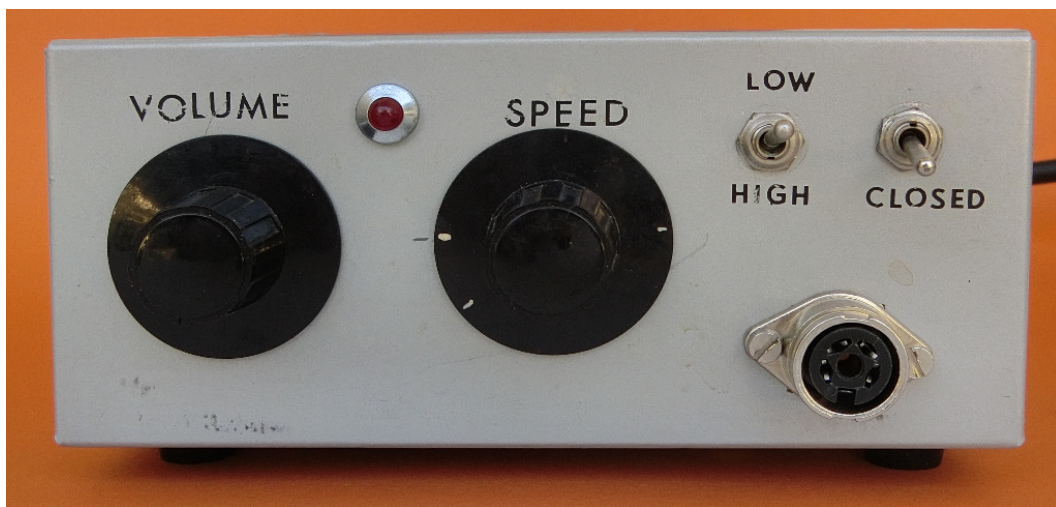
Abbildung 1: Die Taste in TTL Technologie, von vorn. Wie an dem einen Schalter zu erkennen ist, sind zwei Geschwindigkeitsbereiche vorgesehen.
